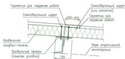
рис. 36. порядок крепления кровельных панелей
