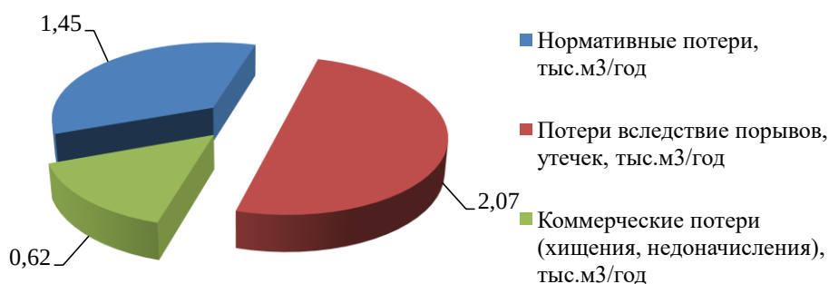
Рисунок 4 – Структурные составляющих потерь холодной воды при ее производстве и транспортировке
