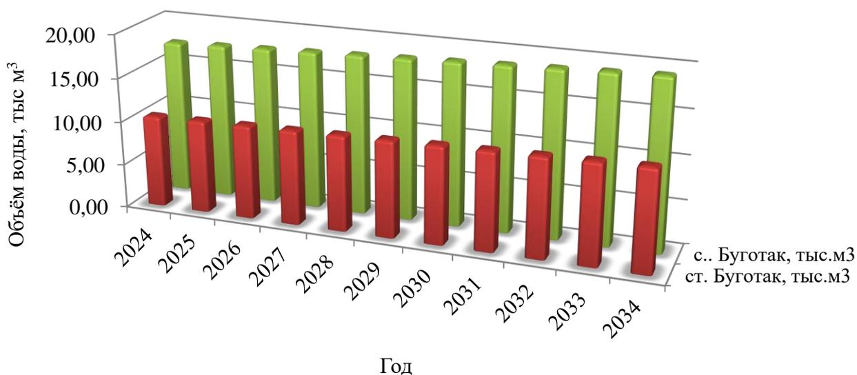
Рисунок 17 – Требуемая мощность очистных сооружений по технологическим зонам водоотведения
